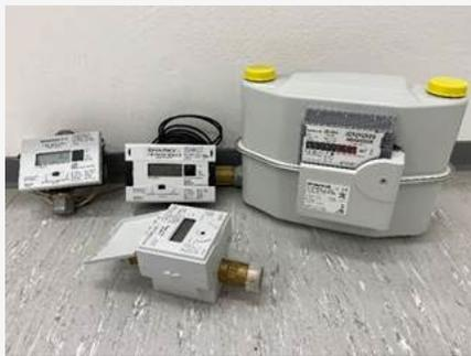
Auch für die weiteren Sparten bereiten wir uns darauf vor, in naher Zukunft intelligente Messsysteme einbauen zu können, da auch hier eine gesetzliche Verpflichtung absehbar ist. Daher testen wir Geräte unterschiedlicher Hersteller, wie im Bild zu sehen, und zusätzlich zu Mobilfunk weitere Kommunikationstechniken, wie LoRaWAN. Informationen dazu, was LoRaWAN ist und wie es funktioniert, finden Sie auf unserer Internetseite [smartmacher.evm.de/smartnet](http://smartmacher.evm.de/smartnet).
